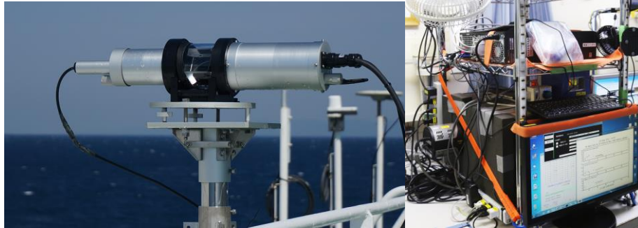
図1 海洋地球研究船「みらい」に設置している MAX-DOAS (マックスドアス) 観測装置の屋外テレスコープ部分 (左) と室内分光器部分 (右)。
