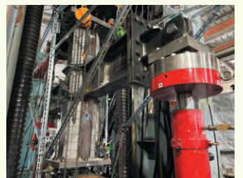
どうしたら建物を地震から守ることができるか、大型試験機で検証
