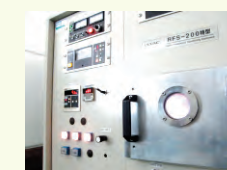
基板上に均質な金属薄膜を成膜するためのスパッタリング装置
