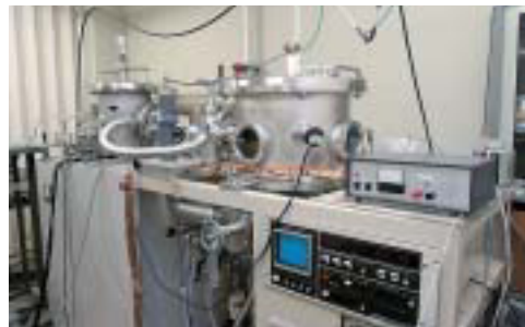
各種ゼオライトのガス吸着質量計測器 (感度10μg、最大200g)
