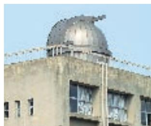
9号館屋上にそびえる天体望遠鏡、知ってた? あれは天体望遠鏡じゃないんだよ。なんでもレーザーを空中に発射してその反射で大気中の黄砂や火山灰などの微粒子を測る機械なんだって。くわしいことは理学部の人や先生に聞いてみるというよ。
