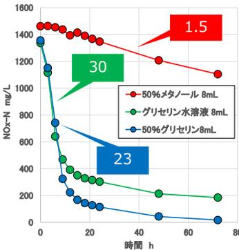
脱窒速度は、グリセリン水溶液で30 mg-N/g-SS・h、50%メタノールで1.5 mg-N/g-SS・hであった。グリセリン水溶液の脱窒速度は、50%メタノールの約20倍であった。次に、純試薬を希釈した50%グリセリンを脱窒剤とした場合、脱窒速度は23 mg-N/g-SS・hとなった。50%グリセリンと比べても、グリセリン水溶液の脱窒速度は約1.3倍となった。この施設では、50%メタノールを常用していないが、グリセリン水溶液の脱窒性能が格段に優れていることが確認された。
