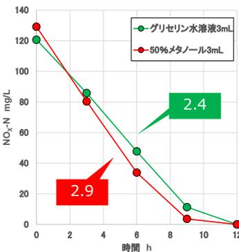
馴化前の脱窒速度は、グリセリン水溶液で1.5 mg-N/g-SS・h、50%メタノールで2.4 mg-N/g-SS・hであった。そこで、脱窒剤を添加して48 h馴化を行った。馴化後の脱窒素試験結果を左図に示す。馴化後の脱窒速度は、グリセリン水溶液で2.4 mg-N/g-SS・h、50%メタノールで2.9 mg-N/g-SS・hにそれぞれ向上した。50%メタノールを常用している施設の活性汚泥では、50%メタノールの脱窒速度の方が優れていた。しかし、馴化によりグリセリン水溶液でも50%メタノールに近い脱窒速度が得られることが確認された。
