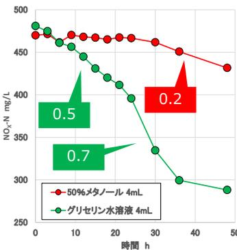
24 hまでの脱窒速度は、グリセリン水溶液で0.5 mg-N/g-SS・hであったが、50%メタノールでは脱窒はみられなかった。24 h以降の脱窒速度は、グリセリン水溶液で0.7 mg-N/g-SS・h、50%メタノールで0.2 mg-N/g-SS・hと、それぞれ脱窒速度が向上した。また、グリセリン水溶液の脱窒速度は、50%メタノールの約3.5倍となった。グリセリン水溶液は、添加後直ちに脱窒が開始されたこと、時間経過により脱窒速度が向上したこと、50%メタノール以上の脱窒速度が得られたことなどから、50%メタノールを常用していない施設の活性汚泥では、グリセリン水溶液の脱窒性能の方が優れていると判断した。
