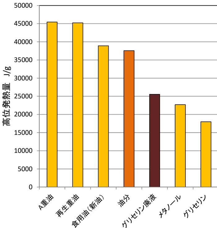
油分の発熱量は、A重油や再生重油の83%、食用油（新油）の96%に相当する。A重油や再生重油と混合し、バイオ重油やバイオ再生重油として工業用燃料利用が可能。
