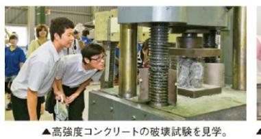
▲高強度コンクリートの破壊試験を見学。(工学部建築学科)
