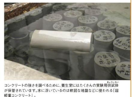
コンクリートの強さを調べるために、養生室にはたくさんの実験用供試体が保管されています。水に浮いているのは軟弱な地盤などに使われる「超軽量コンクリート」。
