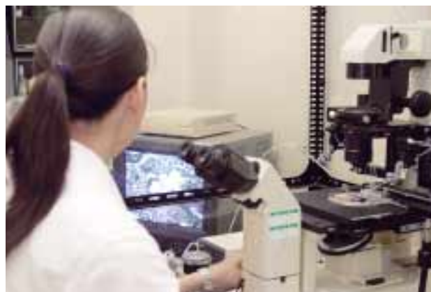
マイクロダイセクション。500~1,000倍の倍率を持つ顕微鏡で細胞を抽出する研究チームのスタッフ
